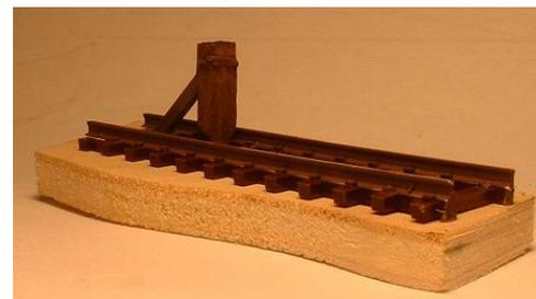
Beim „Typ 2“ (Bild links) handelt es sich um eine Spezialausführung, die an alten oder wenig benutzten Abstellgleisen fest eingebaut werden kann oder, wie konstruktiv vorgesehen, nur bei Bedarf zeitweise verwendet wird. Wenn Module z.B. außerhalb der Heimanlage im Verband mit anderen betrieben wer-
