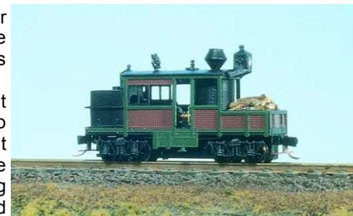
Eingesetzt wurden diese Maschinen in erster Linie auf rasch aufzubauenden Waldbahnen mit extrem engen Radien, die nach Abholzen des Gebietes
